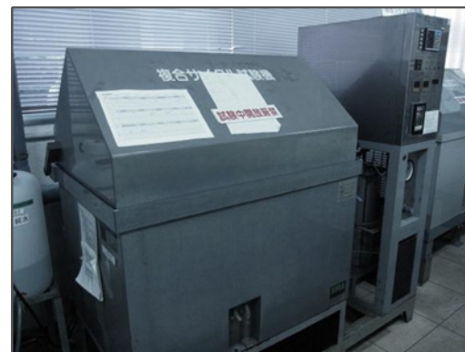
図 1. 複合サイクル試験機(スガ試験機社製)
